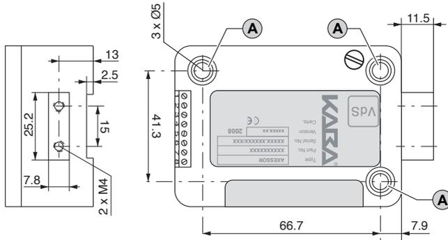
2. Percez les trous de  $\varnothing 5\text{mm}$ . Ebavurez. Tarauder à M6.
