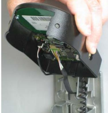
8. Branchez le câble des piles sur le connecteur de la pile à 2-pole et le câble de connexion sur le connecteur de la serrure à 6-pole.
